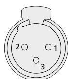
SALIDA DMX Conectores XLR (vista trasera)
